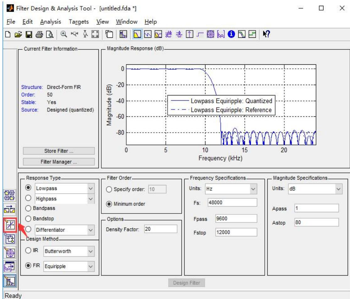
2、由于 FPGA 滤波器的系数需要为整数，因此在此处需要将系数设置为“Fixed-point”，点击上图中红色方框内的按钮，在新出现的页面中将“Filter arithmetic”设置为“Fixed-point”，Filter Precision 可以设置为“Full”设置完成后如下图所示：
