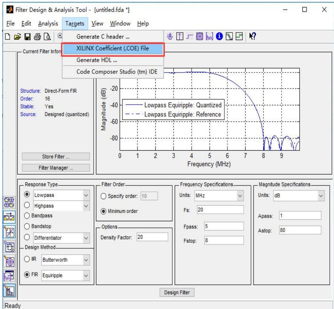
至此，Matlab 配置 FIR 滤波器参数和生成 COE 文件步骤完毕。
