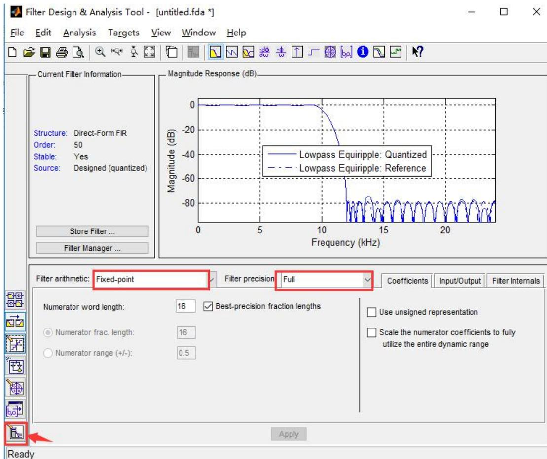
3、点击上图中红色箭头内的按钮，进入滤波器参数设置界面，可以设置采样频率（ $F_s$ ）、通带频率（ $F_{pass}$ ）、阻带频率（ $F_{stop}$ ）以及阻带衰减（ $A_{stop}$ ）等参数，并按照最下面的“Design Filter”按钮生成滤波器系数。如下图所示，采样频率为 20MHz，通带频率为 5MHz，阻带频率为 8MHz，阻带衰减为 -80dB，最后可以点击“Design Filter”查看滤波器抽头个数。
