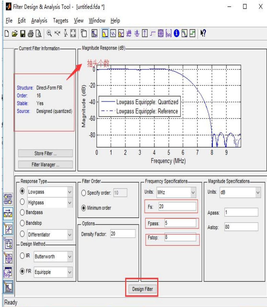
4、导出 coe 文件，点击下图方框中的按钮即可导出 coe 文件，该 coe 文件在 ISE 调用 FIR IP 核时可以直接导入使用。
